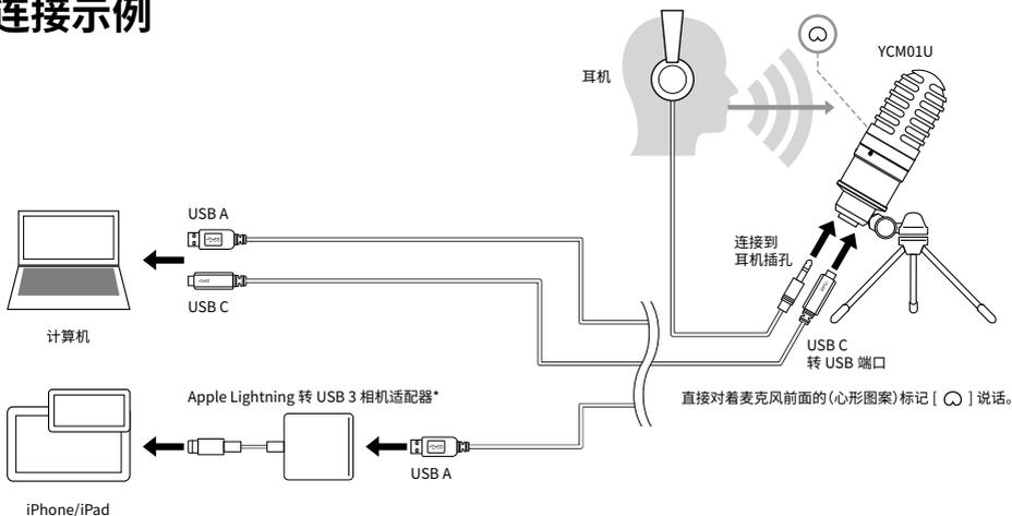
\* 如果您使用的 iPad 支持 USB C 接口，请使用 Apple USB-C 数字 AV 多端口适配器。虽然您可以使用随附的 USB 线缆将本产品直接连接到 iPad，但可用的供电时间可能会受到限制，具体取决于 iPad 的电池电量。
