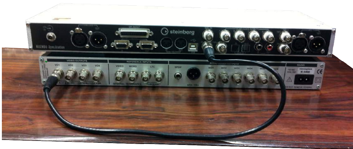
【House sync connected to SyncStation】
