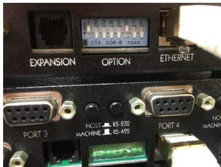
【DIP switches – rear panel】
