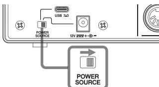
2. 將變壓器的插頭插入後面板上的 DC IN [12V] 插孔。
