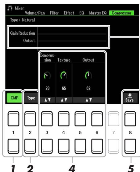
显示 Gain Reduction（压缩程度）和 Output 电平。
