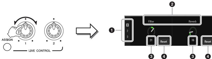
旋转旋钮时，旋钮的当前状态显示在 LIVE CONTROL MONITOR（实时控制监视器）上。
