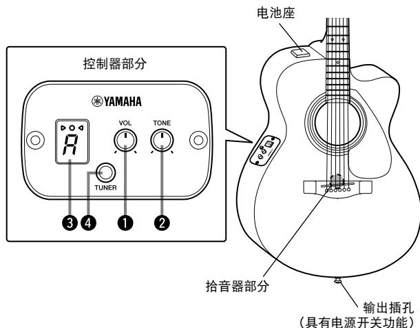
将吉他音频线连接到输出插孔时,内置的前置放大器自动开启。
