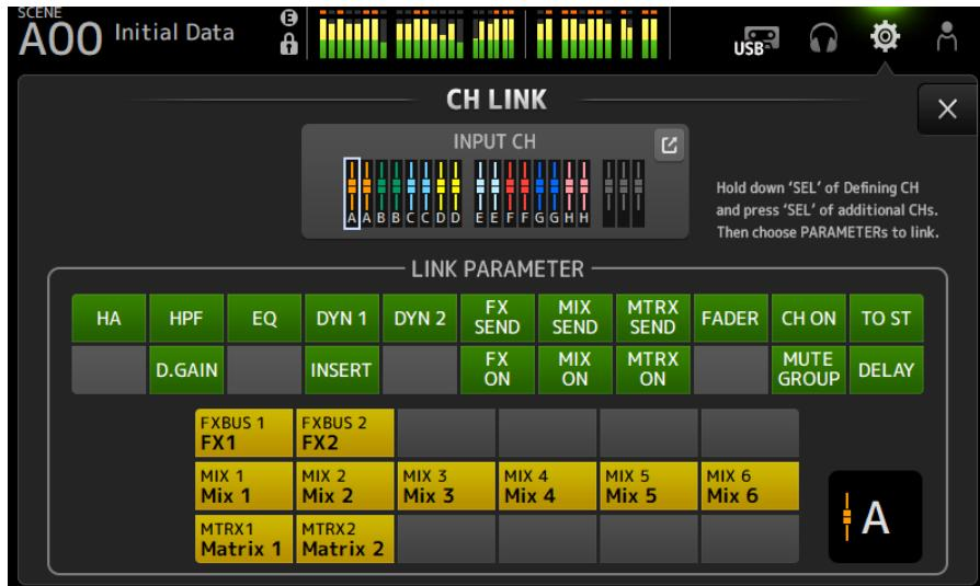
**2 请在按下输入通道链接源的[SEL]键的同时，按下链接目的地的[SEL]键以链接该通道。**
