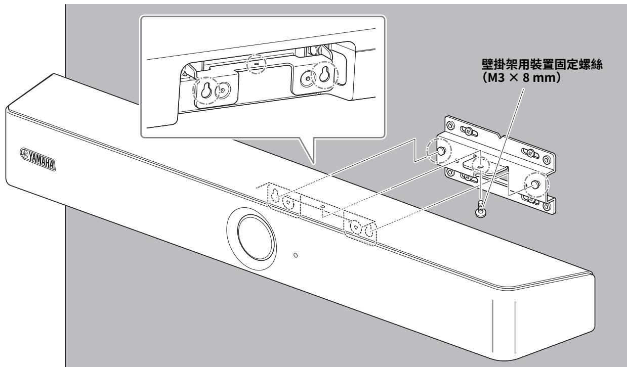
**3. 從壁掛架的下側，使用隨附的壁掛架用裝置固定螺絲（M3 × 8 mm）固定裝置。**
