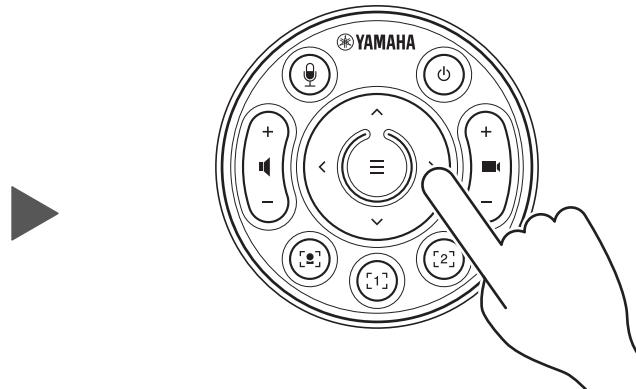
使用平移 / 傾斜按鈕（箭頭按鈕）向上 / 向下 / 向左 / 向右移動游標。
