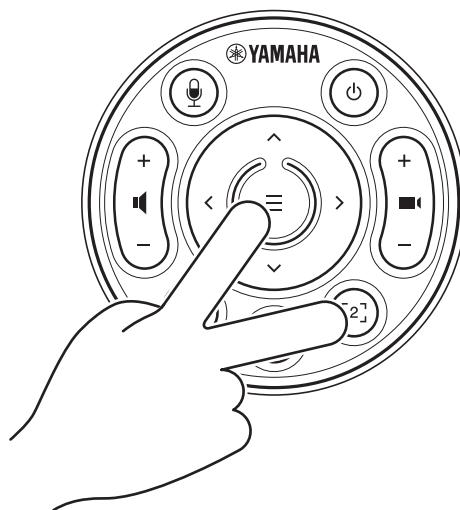
裝置前面板上的狀態指示燈以 0.5 秒為間隔閃爍橘燈五次後，即完成設定。
