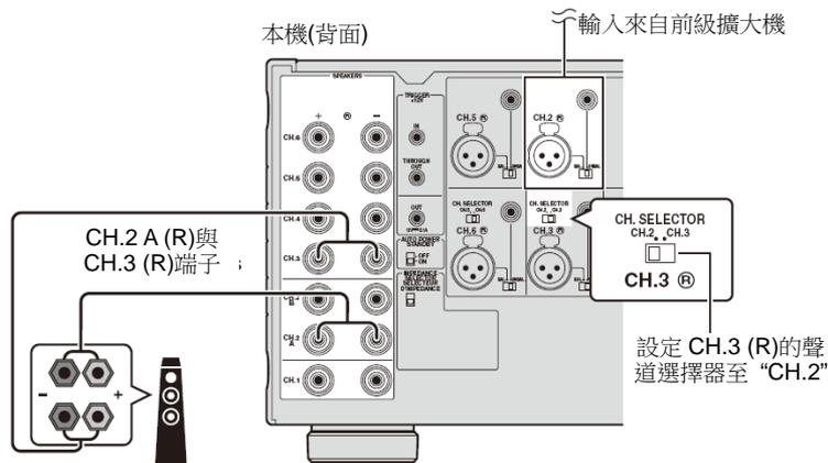
經由設定 CH.3 (R) 的聲道選擇器至 “CH.2”，CH.2 (R) 輸入訊號同時自 CH.2 (R) 和 CH.3 (R) 揚聲器端子輸出。在這種情況下，未使用 CH.3 (R) 的輸入。
