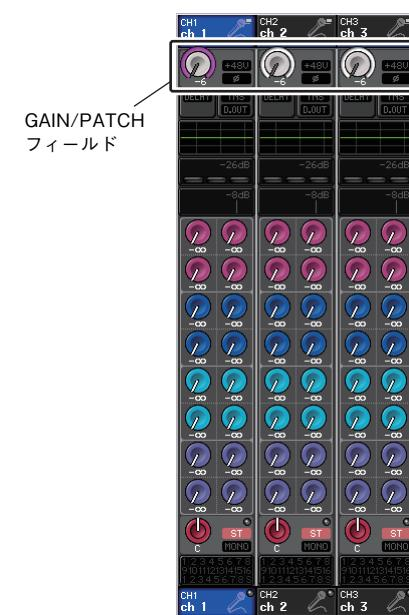
4. I/O デバイスの HA を操作したいチャンネルの GAIN/PATCH フィールドを押して、GAIN/PATCH ポップアップ画面を表示させます。
