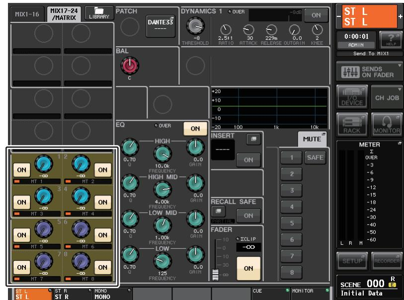
5. 送り先の MATRIX バスに対応する TO MATRIX SEND ON/OFF ボタンがオンになっていることを確認します。
