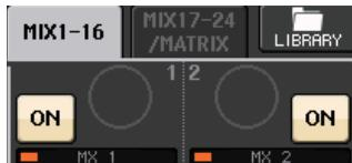
送り先の MIX バスが VARI タイプのとき、または送り先が MATRIX バスのときは、TO MIX SEND LEVEL ノブが SELECTED CHANNEL セクションの対応するノブと同じ色で表示されます。この場合は、SELECTED CHANNEL セクションの対応するノブを使ってセンドレベルを調節できます。
