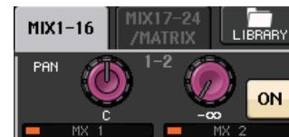
MONO チャンネルでは、右側のノブで 2 系統の MIX/MATRIX バスに共通のセンドレベル、左側のノブで 2 系統の MIX/MATRIX バス間の定位を設定します。左側の TO MIX/MATRIX SEND PAN ノブを左に回すほど奇数番号の MIX/MATRIX バス、右に回すほど偶数番号の MIX/MATRIX バスに送る信号の量が増えます。
