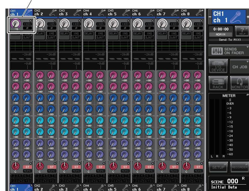
3. HAを操作したいチャンネルのGAIN/PATCHフィールドを押して、GAIN/PATCHポップアップ画面を表示させます。
