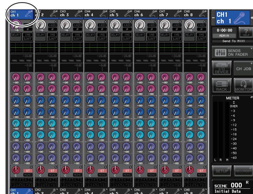
2. 画面最上部のチャンネル番号 / チャンネル名のフィールドを押して、PATCH/NAME ポップアップ画面を表示させます。
