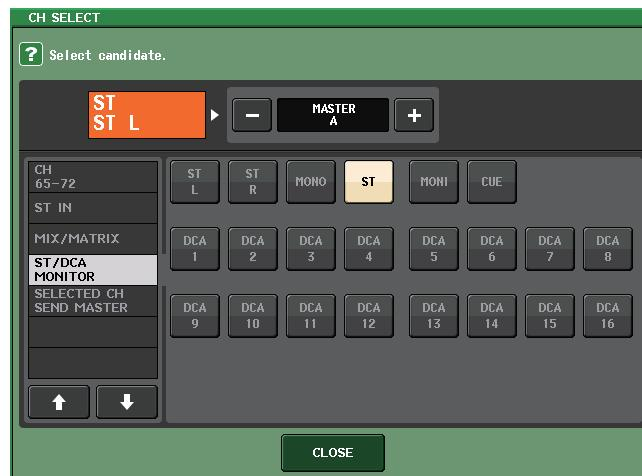
左側のリストから選択したいチャンネルのグループを選び、右側のボタンでチャンネルを選びます。選び終わったら CLOSE ボタンを押します。
