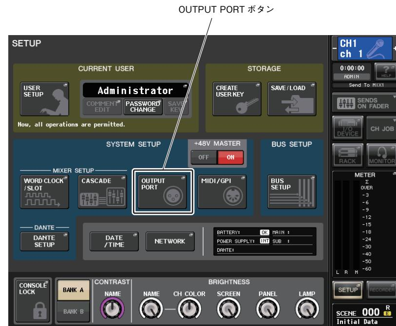
**2. 画面中央にある SYSTEM SETUP フィールドの OUTPUT PORT ボタンを押して、OUTPUT PORT ポップアップ画面を表示させます。**
