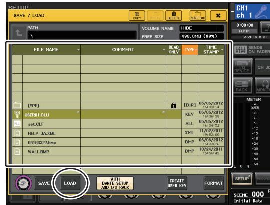
3. ファイルリストに表示されたファイルを押す、またはパネル上のマルチファンクションノブを回して、ロードしたいファイルを選択します。
