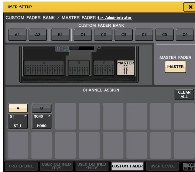
5. 変更したいフェーダー(AまたはB)のチャンネルセレクトトップアップボタンを押してチャンネルを選択します。
