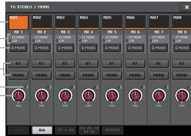
なお、ST/MONO/LCR モード選択ボタンが LCR モードに設定されているときは、STEREO/MONO ボタン(④)のかわりに、次のボタン / ノブが表示されます。
