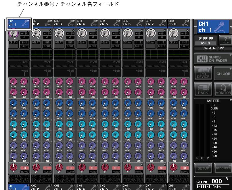
2. チャンネル名 / アイコン / チャンネルカラーを設定したいチャンネルのチャンネル番号 / チャンネル名フィールドを押して、PATCH/NAME ポップアップ画面を表示させます。
