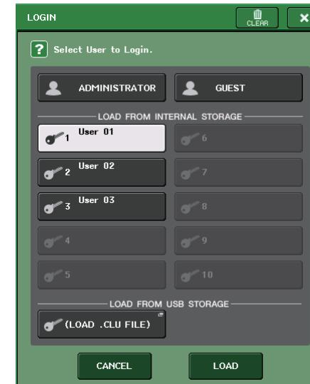
3. LOAD FROM INTERNAL STORAGE フィールドからログインしたいユーザーのユーザー認証キーを選択して LOAD ボタンを押します。
