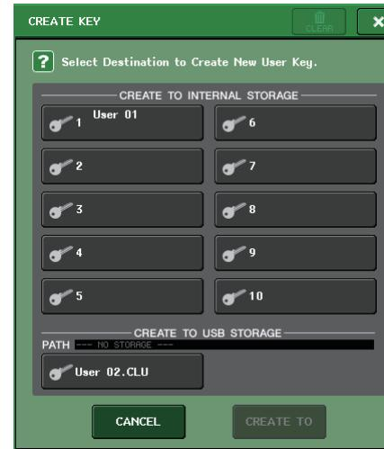
5. 本体の内部メモリーにユーザー認証キーを作成する場合は、CREATE TO INTERNAL STORAGE フィールドのボタンを押して保存先を選びます。
