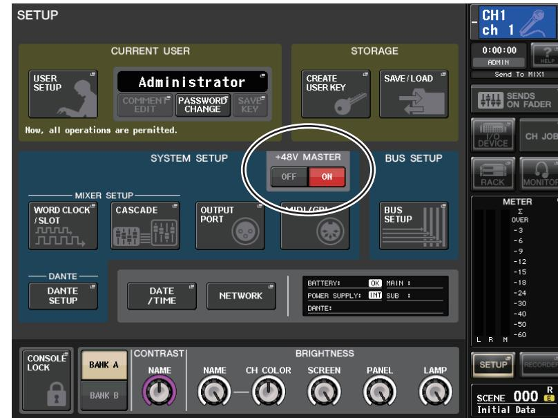
**2.** SETUP 画面の中央にある +48V MASTER フィールドで、ON ボタンもしくは OFF ボタンを押します。
