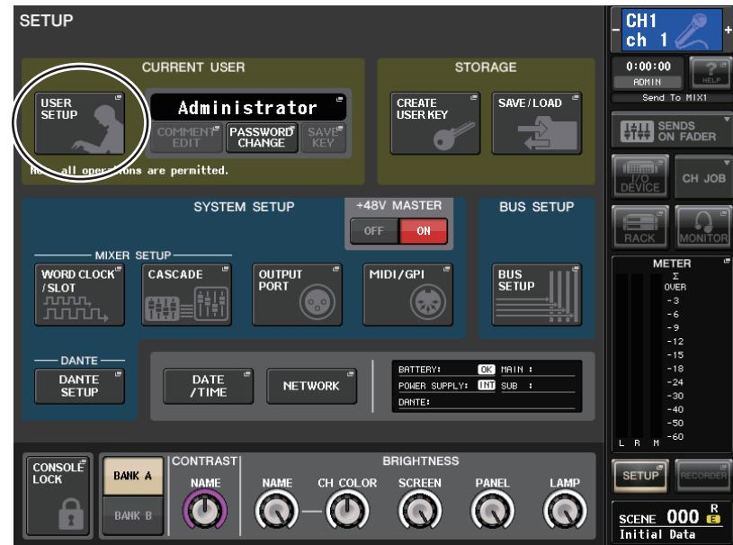
2. 画面左上のUSER SETUPボタンを押して、USER SETUPポップアップ画面を表示させます。
