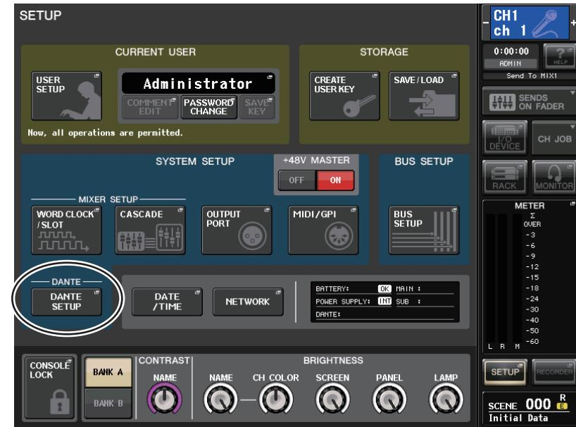
2. 画面中央の DANTE フィールドにある DANTE SETUP ボタンを押して、DANTE SETUP ポップアップ画面を表示させます。
