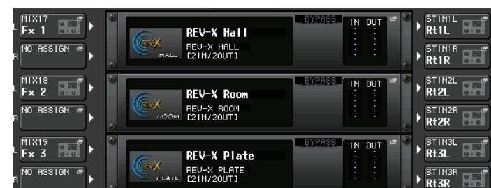
**2. INPUT PATCH L ボタンを押して CH SELECT ポップアップ画面を表示させ、ラックの入力元として MIX チャンネルを選びます。**
