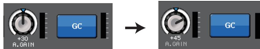
このとき、CL シリーズに入力される各信号のゲインは CL シリーズのデジタルゲインで調節します。1 台の I/O デバイスを共用で、FOH 卓とモニター卓を使用するときに、たとえば FOH 卓でアナログゲインを動かしても、オーディオネットワークに流れる信号が一定のレベルになるので、モニター卓の入力レベルに影響しません。
