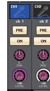
送り元がステレオの場合は、TO STEREO/MONO ポップアップ画面の PAN/BALANCE モードで PAN か BALANCE を選べます。
