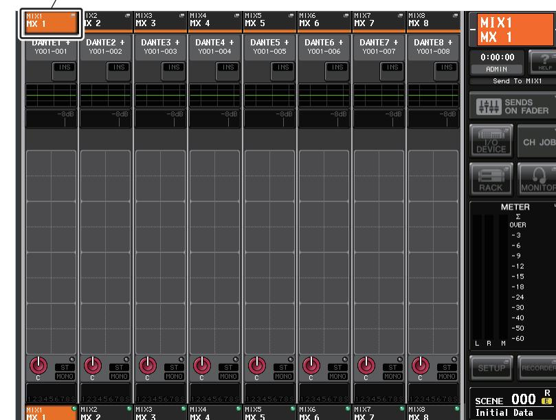
2. チャンネル名/アイコン/チャンネルカラーを設定したいチャンネルのチャンネル番号/チャンネル名フィールドを押して、PATCH/NAME ポップアップ画面を表示させます。
