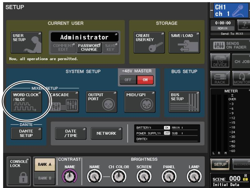
2. 画面中央のSYSTEM SETUP フィールドにあるWORD CLOCK/SLOT SETUPボタンを押して、WORD CLOCK/SLOT SETUP ポップアップ画面を表示させます。
