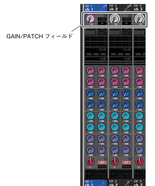
9. 外部 HA を操作したいチャンネルの GAIN/PATCH フィールドを押して、GAIN/PATCH ポップアップ画面を表示させます。
