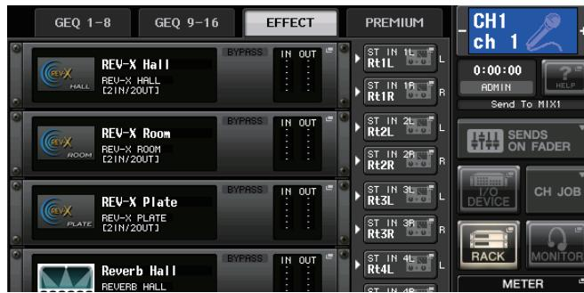
2. VIRTUAL RACK ウィンドウ上部のGEQ1-8、GEQ9-16 または EFFECT タブを押して、GEQ フィールドまたは EFFECT フィールドを表示させます。
