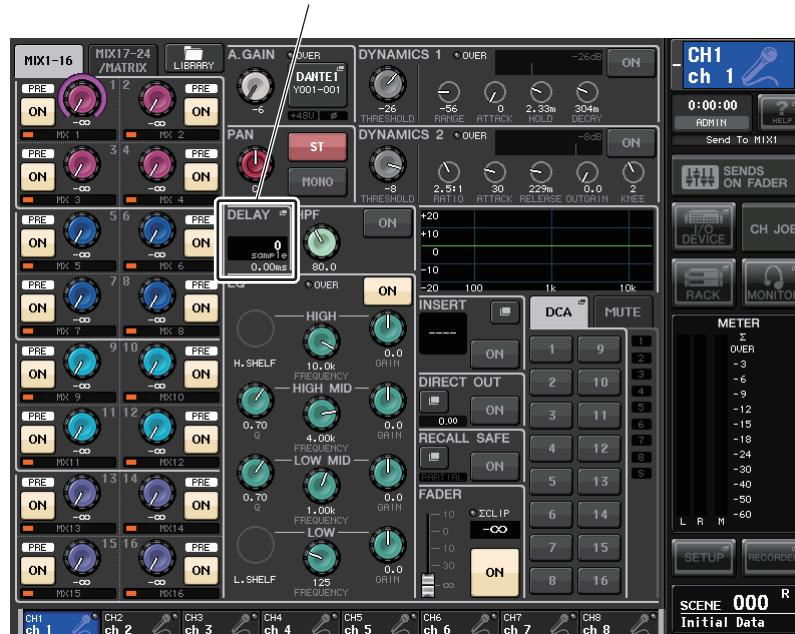
3. INPUT DELAY フィールドを押して INPUT DELAY ポップアップ画面を表示させます。
