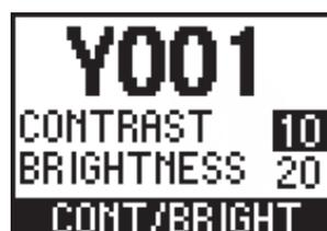
此屏幕允许您设置显示屏的对比度和亮度。此操作还允许您设置彩条指示灯的亮度。按住 [↔] (返回) 按键以显示此屏幕。
