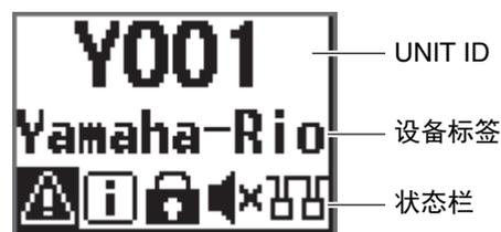
打开电源开关时，会出现此屏幕。上方的行显示 UNIT ID。初始值为 Y001。中间的行显示设备标签的一部分。底部的行显示状态栏，其中会使用图标来表示设备的状态。
