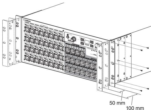
机架安装硬件也可以使用相同的方式安装到后面板表面。
