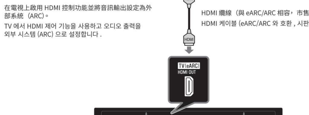
在電視上啟用 HDMI 控制功能並將音訊輸出設定為外部系統 (ARC)。
