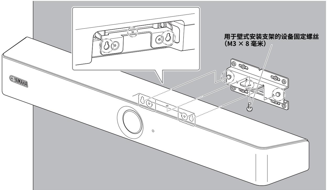
**3. 在壁式安装支架的底部，使用随附的用于壁式安装支架的设备固定螺丝 (M3 × 8 毫米) 固定设备。**
