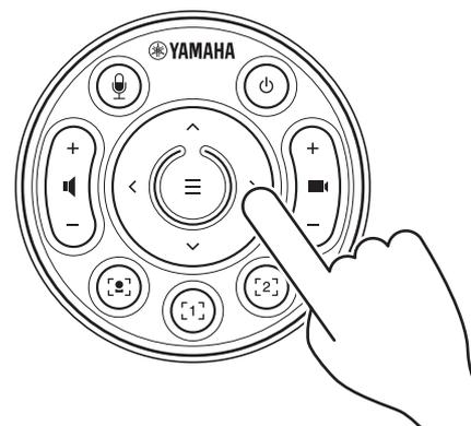
使用平移 / 倾斜按钮（箭头按钮）向上 / 向下 / 向左 / 向右移动光标。
