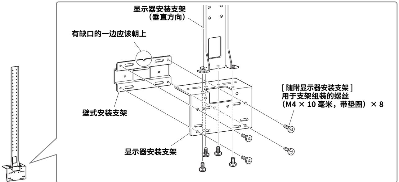
**2. 使用随附的螺丝，安装显示器安装支架（水平方向）和步骤 1 中组装的支架。**
