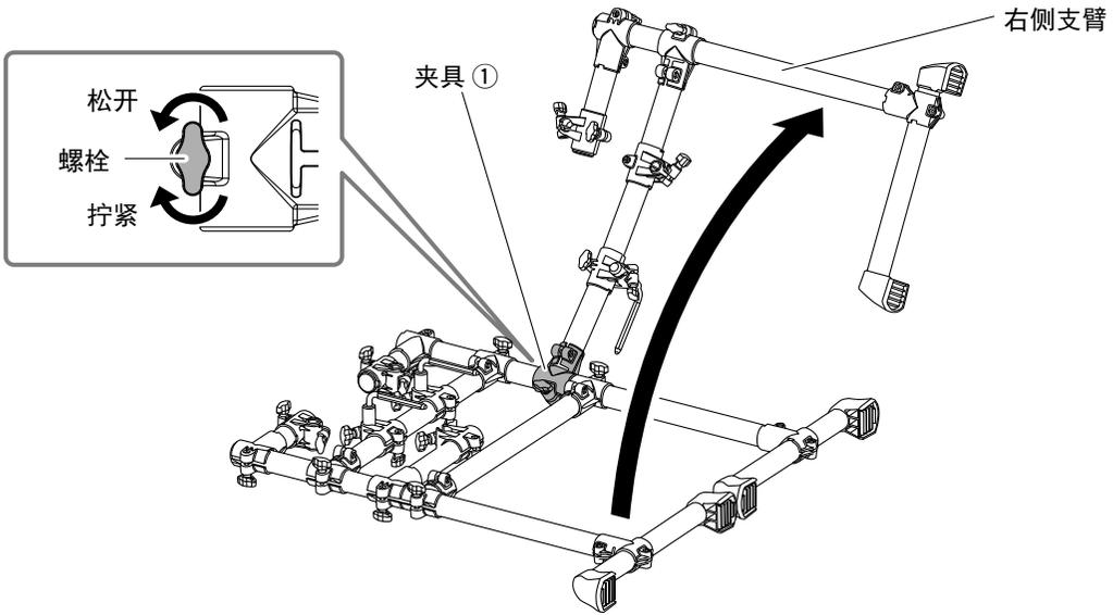
2. 将架子直立在平坦的地板上，然后根据可用空间调整右臂的开度。
