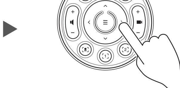
使用平移／傾斜按鈕（箭頭按鈕）向上／向下／向左／向右移動游標。
