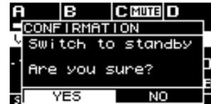
2. 转动主旋钮选择“YES”,然后按下主旋钮确认;电源开关切换至待机模式。
