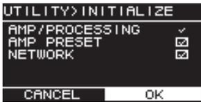
3. 转动主旋钮，选择要初始化的设置类型（可以选择多个），然后按下主旋钮进行确认。
