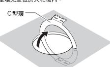
3. 將附帶的2個螺絲擰入2個C型環的凹槽,以固定C型環和輔
