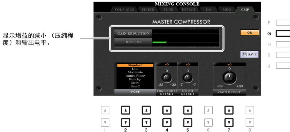
显示增益的减小（压缩程度）和输出电平。
