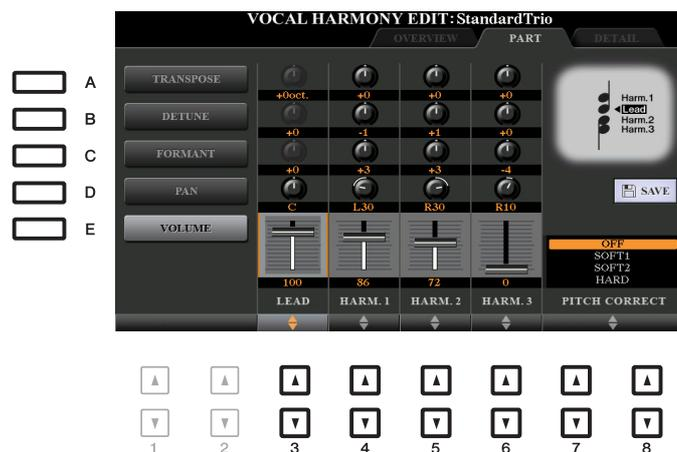
使用 [A]-[E] 按钮选择需要的参数，然后根据和声音符（和声 1、2、3）和主唱音色（您自己的音色），使用 [3 ▲▼]-[8 ▲▼] 按钮编辑每个人声部分。
