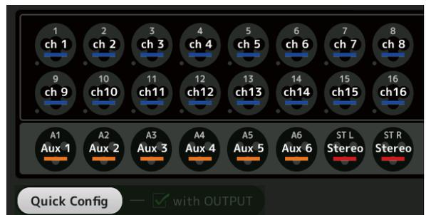
7. 若要将 Tio1608-D2 输入指定到 TF 系列调音台，请将调音台 INPUT 画面上的输入选择设置为“SLOT”。
