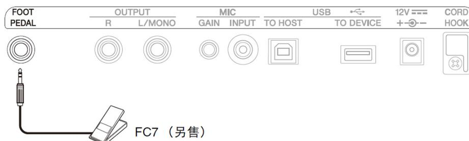
可以透過踏板操控以下功能：音量控制、[HOLD]按鈕、[START/STOP]按鈕或[REC]按鈕。如需使用踏板操控這些功能，請將[SETTING]按鈕的值更改為“Foot Pedal”(第 30 頁)。
