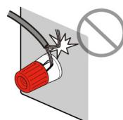
如果前顯示器在本機開啟時出現 “Check SP Wires”，請關閉本機然後檢查揚聲器訊號線短路。
