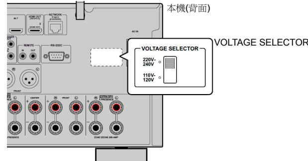
完成所有連接後，將隨附的電源線接到本機後再插入 AC 牆壁插座。
