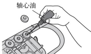
2. 在转阀上所有转动的部位上,也滴上2-3滴轴心油,重新盖好转阀盖,再按动按键数次,使转轴油均匀地扩散。
