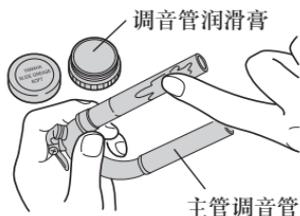
2. 装回主管调音管后将其来回拉动数次,使调音管润滑膏均匀扩散。
