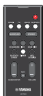
Mando a distancia * El mando a distancia ya tiene una pila de litio CR2025.
