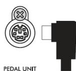
將裝置的連接器確實插入，直到電線插頭的金屬部分在與插圖中相同的方向消失不見。否則，連接器可能會損壞，踏板可能無法正常運作。
